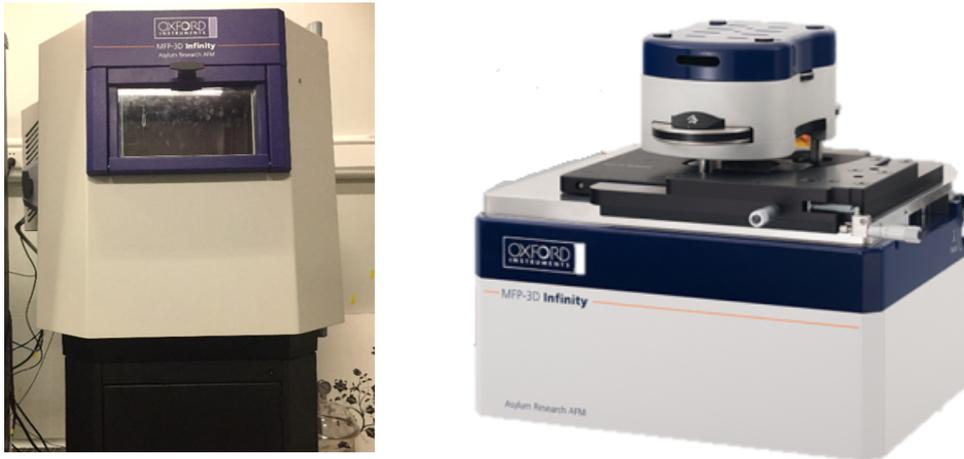
图 3.8 实验中使用的 AFM MFP-3D 及其测头
